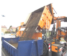
Entleerung des Auffangbehälters
